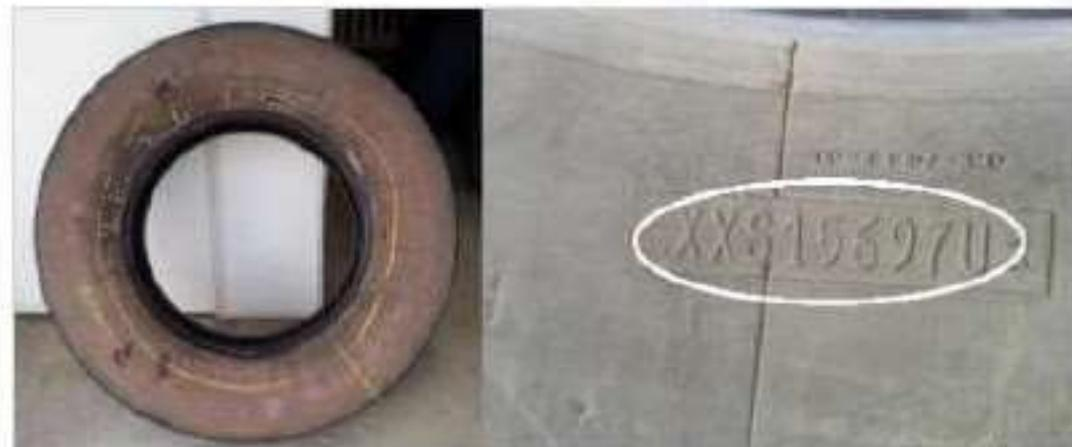
Prenez une photo du matricule s'il existe ou une photo du flanc complet du pneu si le
